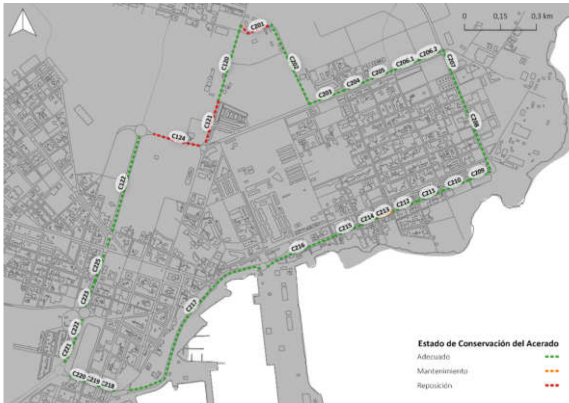
Ilustración 39. Estado de conservación del acera en el IPA 2: C2. Fuente: Elaboración Propia
