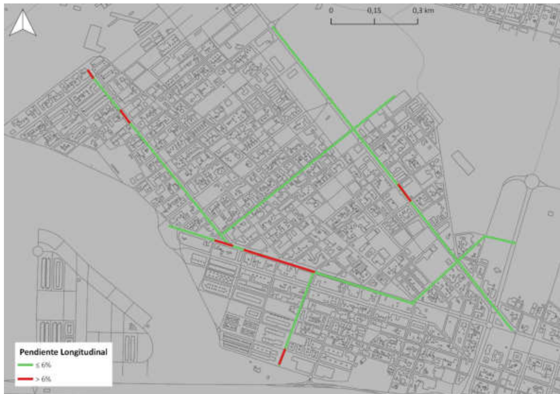
Ilustración 83. Pendientes longitudinales IPA1 – L2. Fuente: Elaboración Propia
