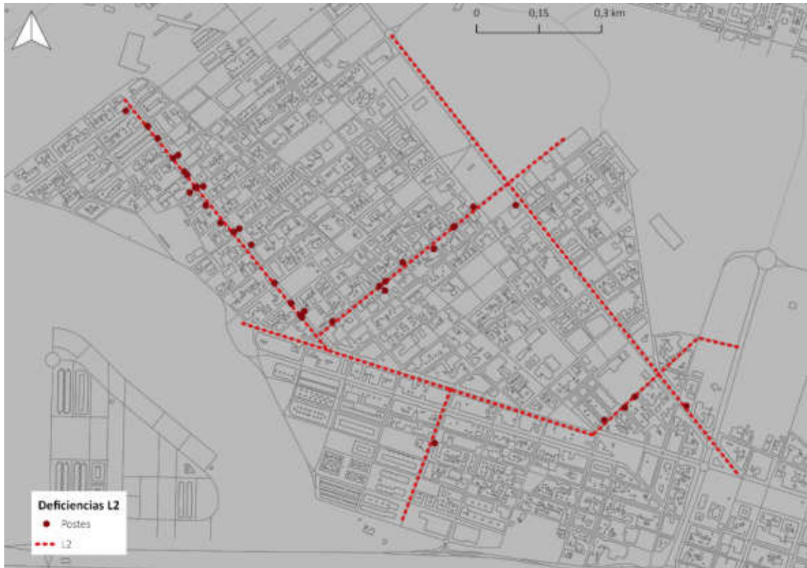
Ilustración 86. Postes IPA1 – L2. Fuente: Elaboración Propia
