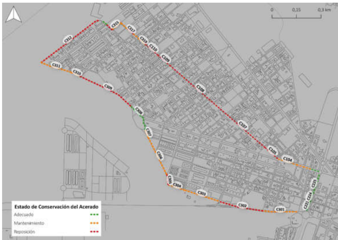
Ilustración 56. Estado de conservación del acerado en el IPA 3: C3. Fuente: Elaboración Propia
