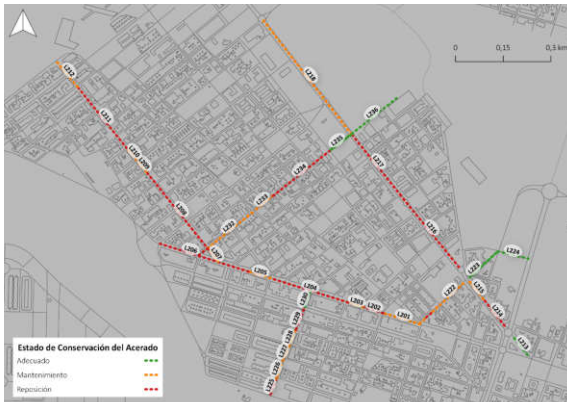
Ilustración 93. Estados de conservación del acerado IPA2 – L2. Fuente: Elaboración Propia
