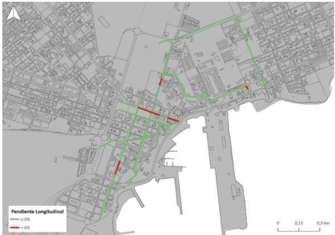
Ilustración 64. Pendientes longitudinales IPA1 – L1. Fuente: Elaboración Propia
